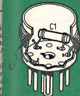
Fig. 4 - Schema di collegamento fra la bobina di sintonia e lo zoccolo octal portabobina, visto dalla parte di sopra (i piedini dello zoccolo in questo caso vengono contati alla rovescia).
